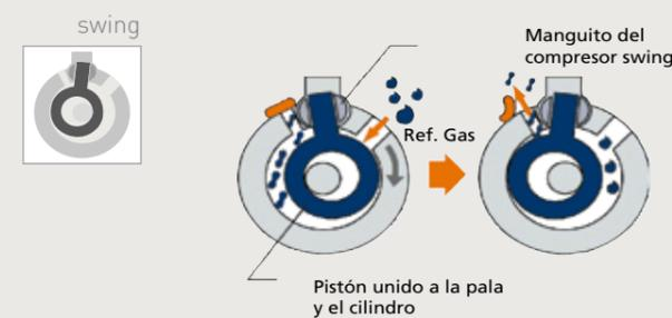
La nueva gama de mini enfriadoras está equipada con un compresor swing. Este innovador diseño de Daikin, con menos componentes móviles, permite un funcionamiento más fiable y suave, con niveles de ruido y de vibración realmente bajos. El motor de alta eficiencia reduce el consumo de energía, lo que se traduce en un mayor ahorro en los costes energéticos.
