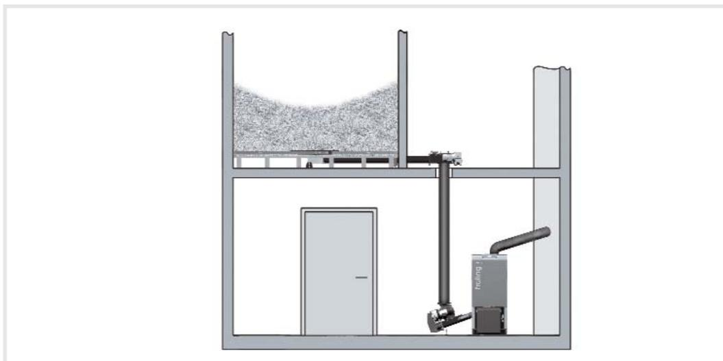
Silo por encima de la sala de calderas. El combustible llega a la caldera a través de un tubo de caída por gravedad.
