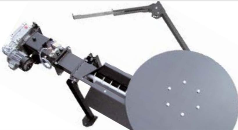
Para la extracción de combustibles de silos con un diámetro máximo de 6 metros.
